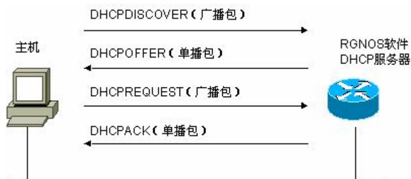
图 1 DHCP 基本工作流程
